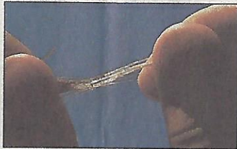
Starke Faser: So sieht das Produkt der ersten Verarbeitungsstufe aus – ein Vlies, vor dem Hintergrund des nachwachsenden Rohstoffes Brennessel
